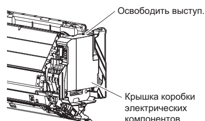
Рис. 1. Снятие крышки с коробки электрических компонентов
